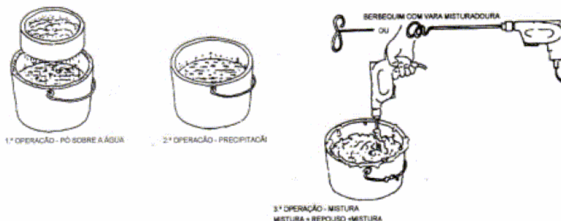
Figura XVI.4 – Aplicação manual de pastas compósitas.
