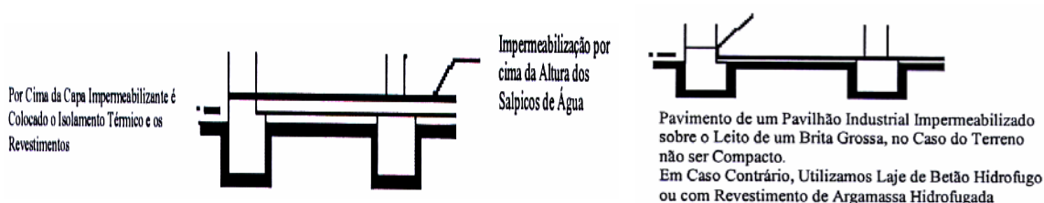
Figura XIV.1 – Impermeabilização contra a humidade ascendente.
