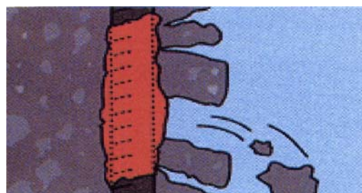
Destruição do recobrimento do betão devido à oxidação, e respectivo aumento de volume, das armaduras de aço.
