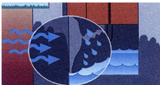
Deterioração das telas protectoras (asfálticas) devido à pressão da água.
