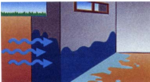
Infiltração através dos poros do betão ou do material constituinte da parede.
