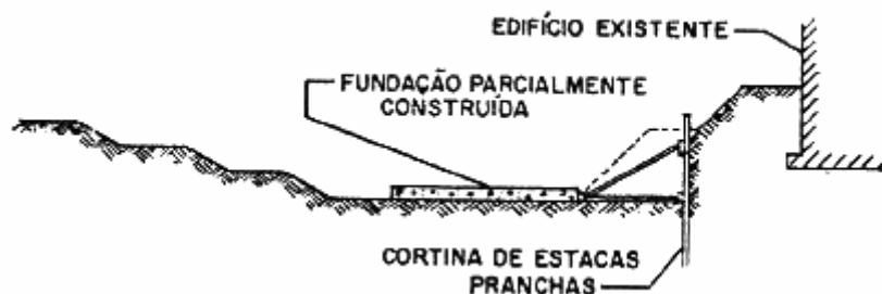
Figura V.8 – Escavação escorada na fundação do edifício a construir.
